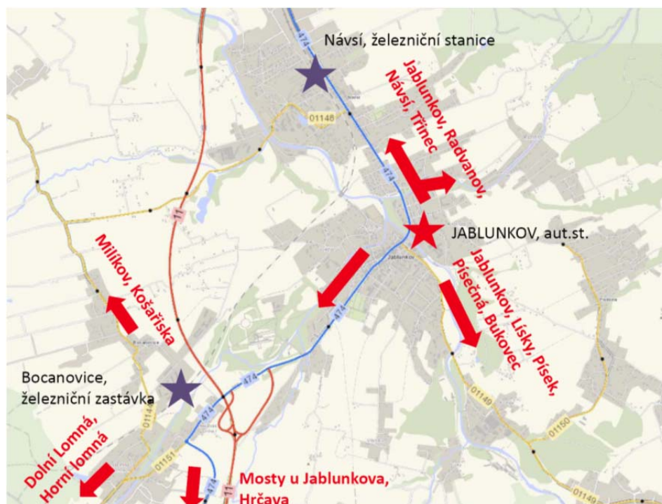
Obr.: Paprskovité vedení linek z autobusového terminálu v Jablunkově
